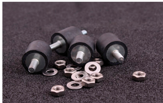
Fig 3a - De medföljande gummibussningarna måste användas vid montering annars kommer inte accelerometern att fungera!
